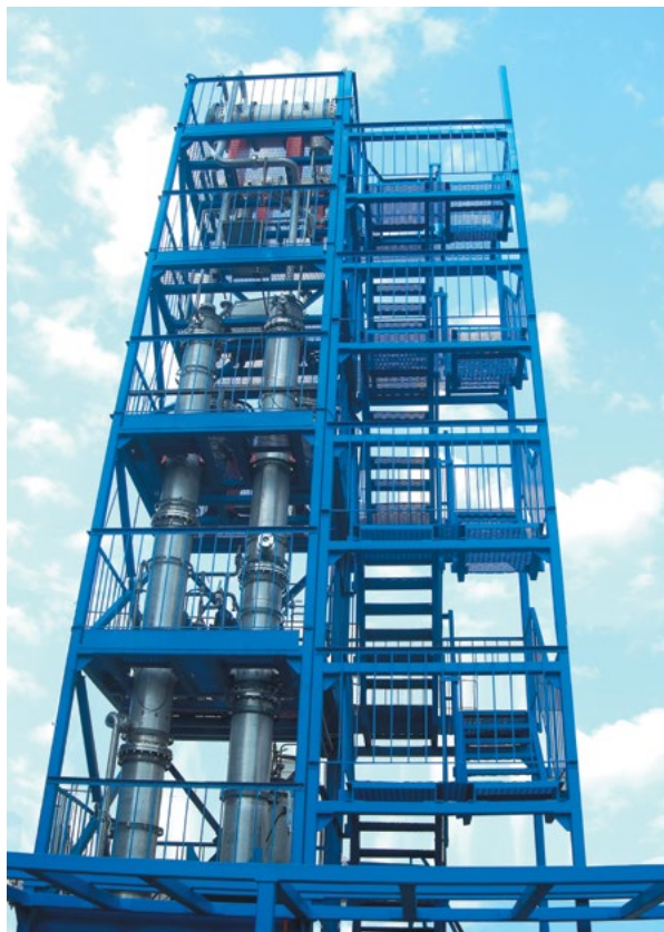
Рис 2. Колонное оборудование, оснащенное сетчатыми насадками серии «Шеврон» (ОАО «Электрогорский институт нефтепереработки»)
