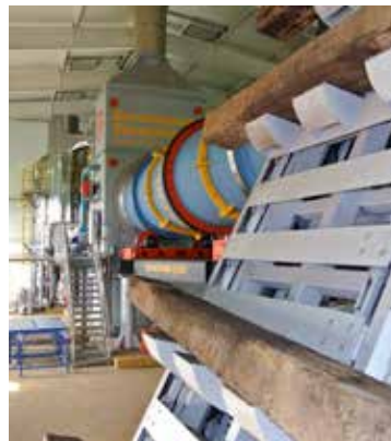
Комплекс термического обезвреживания шпал КТО-1000.Ш
