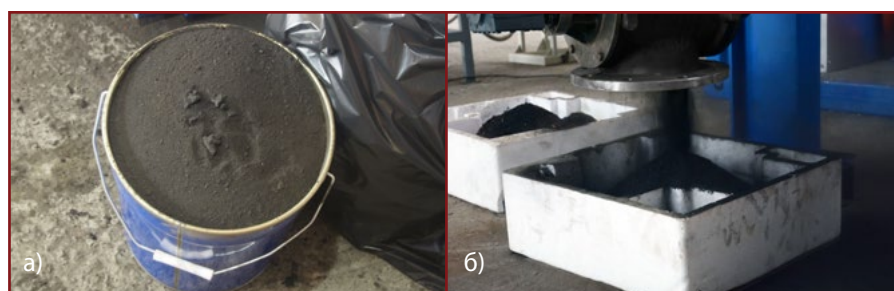
Сухой остаток: а) технический грунт (от утилизации нефтешламов), б) технический углерод (от утилизации РТИ)
