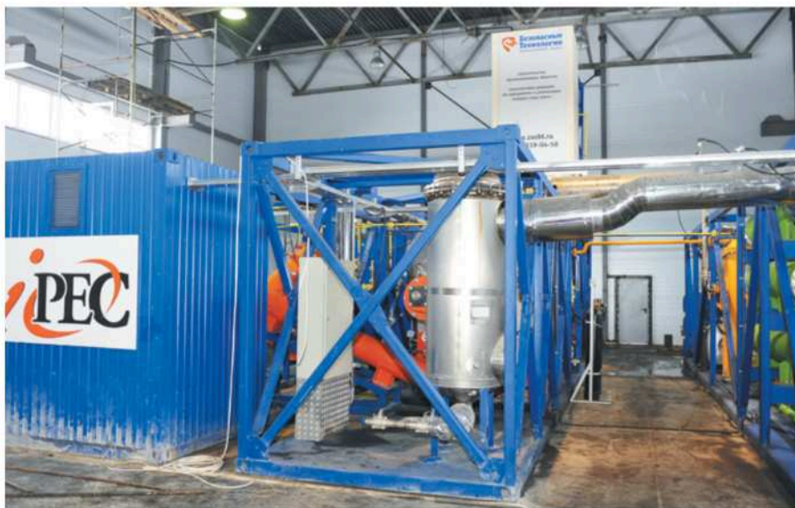
Установка Термической Деструкции УТД-2-800 для переработки автомобильных шин и отходов РТИ, Смоленская обл.
