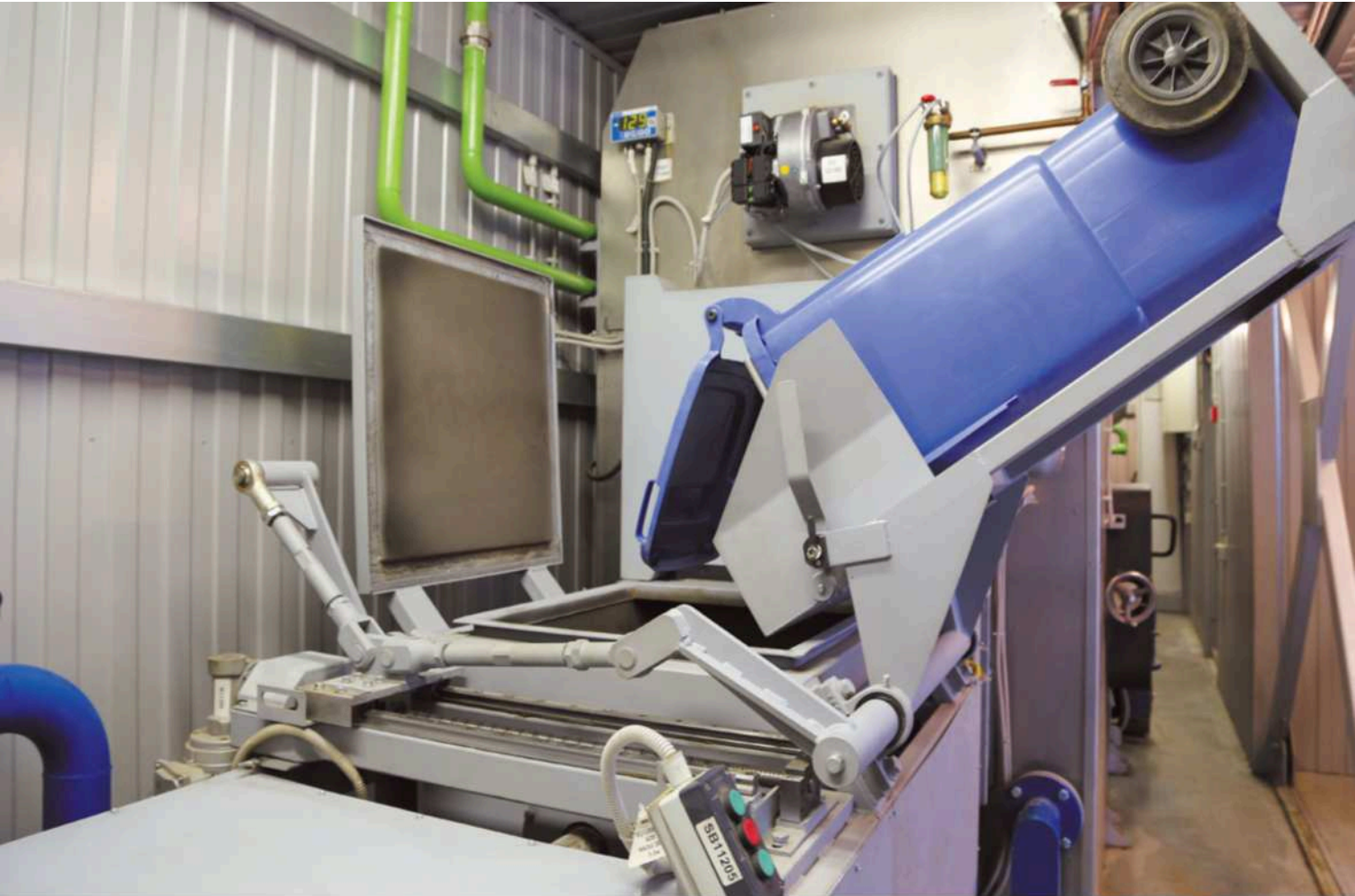
Серийный инсинератор КТО-50.К40. Автоматическое загрузочное устройство исключает контакт обслуживающего персонала с опасными медицинскими отходами
