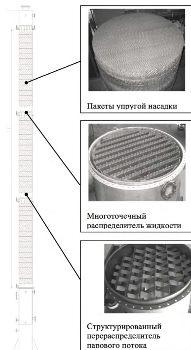
рис. 1 Основные узлы колонны с РН.
