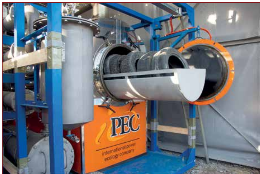
Установка термической деструкции циклического действия
