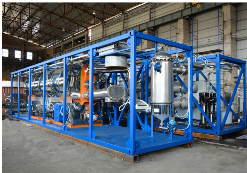
Фото 4 – Установка термической деструкции УТД-2
