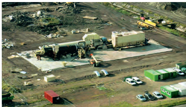
Термодесорбционный комплекс Tarmac
