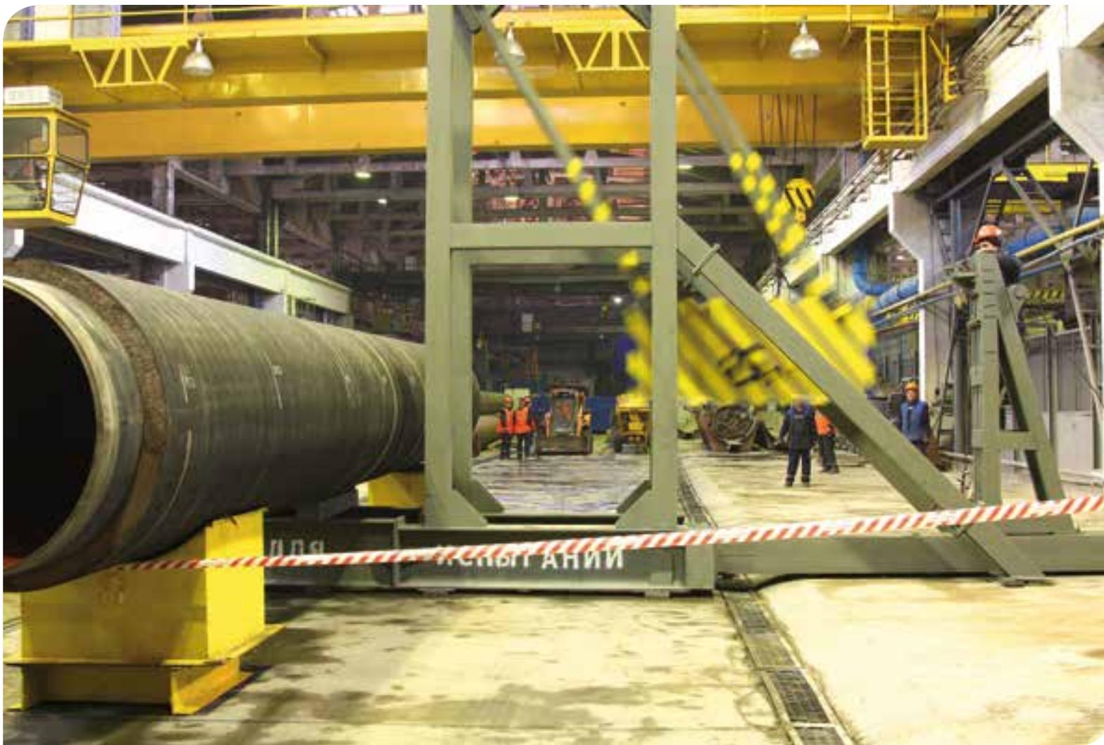
Испытания покрытия на многократный удар
