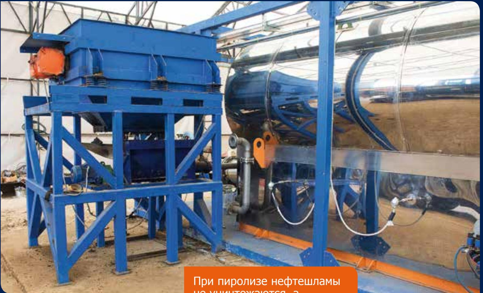
По результатам запуска УТД-2 администрация Вынгапуровского месторождения планирует полностью переработать содержимое шламовых амбаров и перейти на безамбарные технологии добычи нефти. Испытания новой установки и опыт ее эксплуатации подтвердили, что оборудование, созданное промышленной группой «Безопасные Технологии», не имеет аналогов в России как по технологическому процессу непрерывного пиролиза, так и по экономичности и эффективности его аппаратной реализации.
