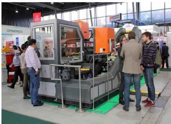
Интересна новинка, которая сравнительно недавно появилась на российском рынке — оптические сепараторы. На выставке его представил производитель — норвежский концерн Tomra Sorting. Оборудование позволяет автоматически сортировать отходы при помощи лазерной оптики, разделяя их на два потока: нужные и ненужные. При помощи программы задаются определенные параметры, материал и цвет сырья. Например, сортировщик может получить только зеленое стекло, или смесь бумаги и бутылок ПЭТ.
