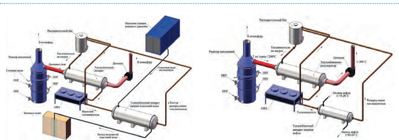
Рис. 2. Комплекс использования ПНГ для нагрева пластовой воды
