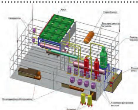
Установка может работать как энергетический комплекс, производящий наряду с метанолом топливный газ. Последний может быть использован в качестве топлива электрогенераторов, котельных и установок для утилизации отходов.
