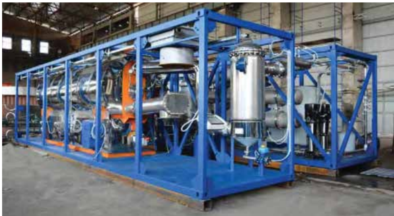
Установка Термической Деструкции УТД-2-800
